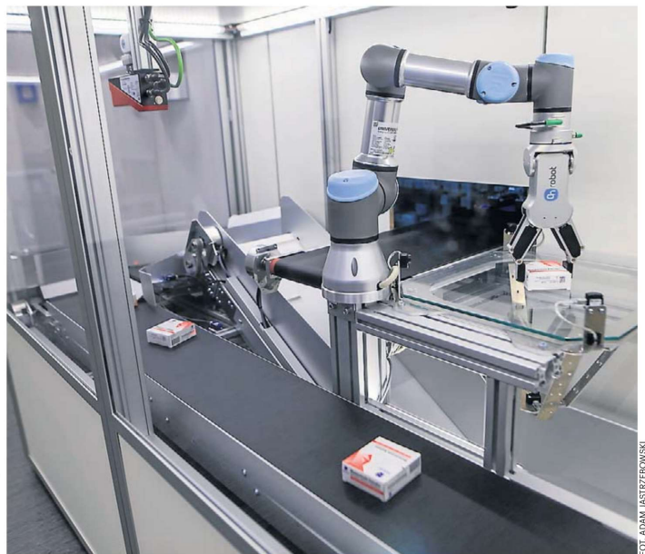
Robot bierze lek, układa na szklanej półce, skanuje za pomocą kamer. Następnie opakowania przejeżdżają do magazynu, gdzie kolejne ramię odkłada je na konkretne półki
